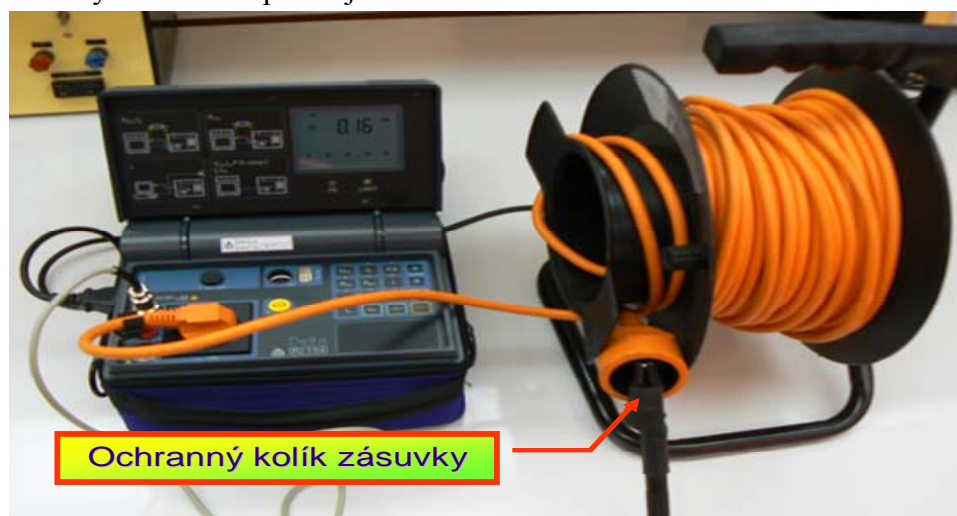
Obr. 4 Príklad merania odporu ochranného vodiča R_{PE} na elektrickom predmete triedy ochrany I meracím prístrojom PU 194 10 A Delta fi. Metra Blansko
