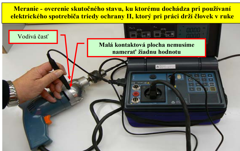
Obr. 10 Príklad merania dotykového I_F (zistením rozdielového) prúdu
