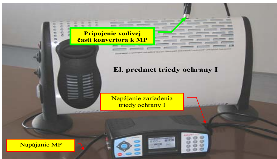
Obr. 3 Príklad merania odporu pospájania – ochranného vodiča R_{PE} na elektrickom predmete triedy ochrany I meracím prístrojom AlphaPAT MI 2142 fi. METREL
