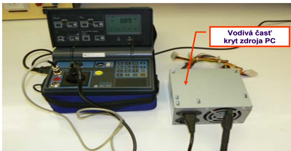
Obr. 10 Príklad merania odporu ochranného vodiča R_{PE} na spotrebiči/PC zdroji meracím prístrojom PU 194 10 A Delta
