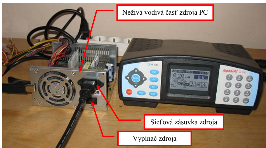
Obr. 17 Príklad merania dotykového prúdu I_F (zistením rozdielového prúdu)
